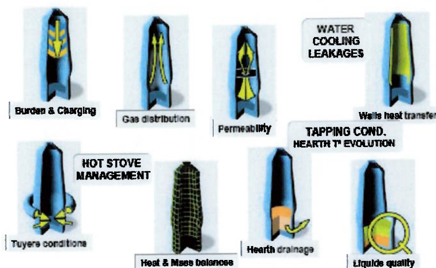
Figura 29 - Áreas do processo do Alto Forno monitoradas / controladas por um Sistema Especialista
